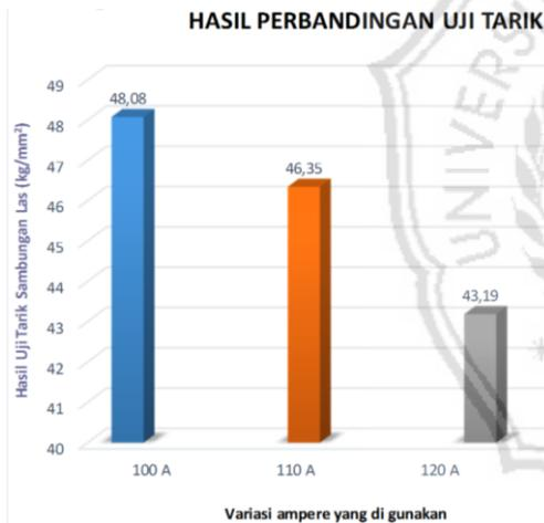
Gambar 5 Diagram perbandingan kekuatan uji Tarik
