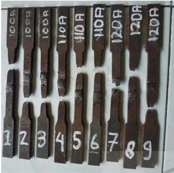
Gambar 12 Hasil Uji Spesimen 100 A , 110 A dan 120 A
