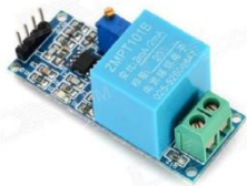
Gambar 2.4 Sensor Tegangan ZMPT101b
