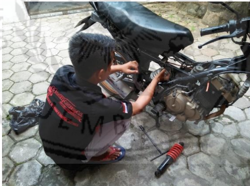
Gambar : (b) proses pemasangan shockbreaker .
