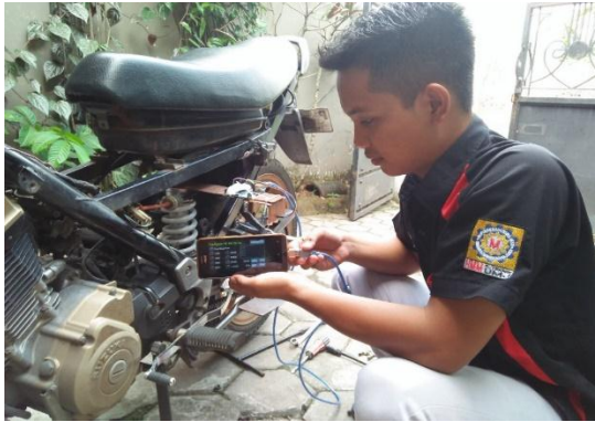
Gambar : (a) pemasangan skema alat uji pada shockbreaker variasi.
