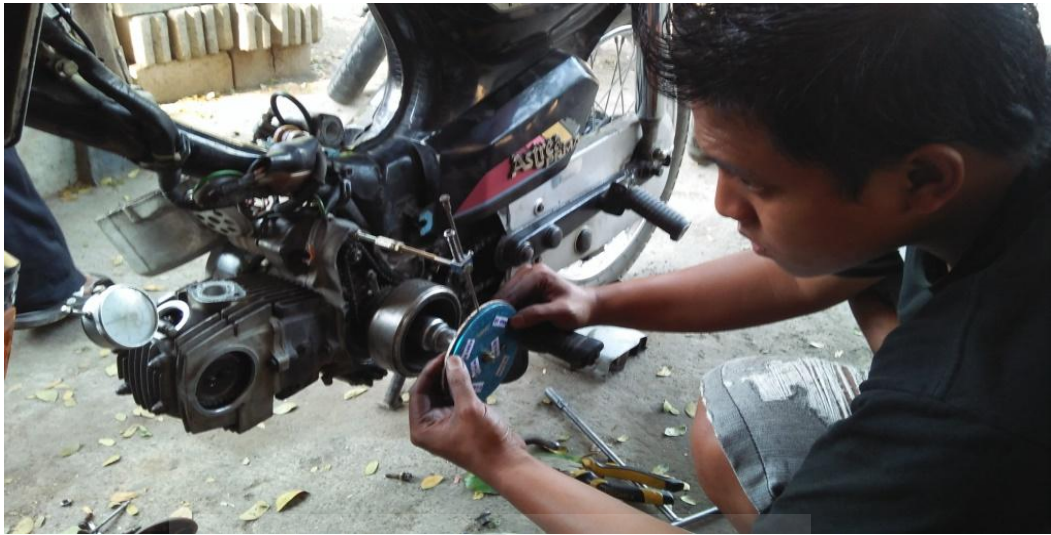
Gambar proses menghitung lift camshaft menggunakan Dialtest
