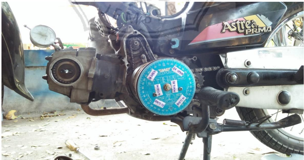
Gambar alat Dialtest yang terpasang pada motor
