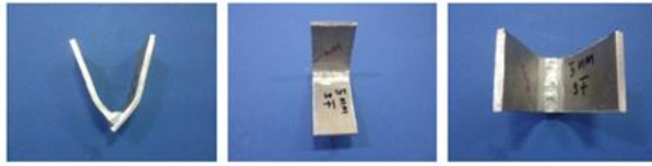
Gambar 14. Spesimen Uji Ketebalan 5 mm Posisi 3F
