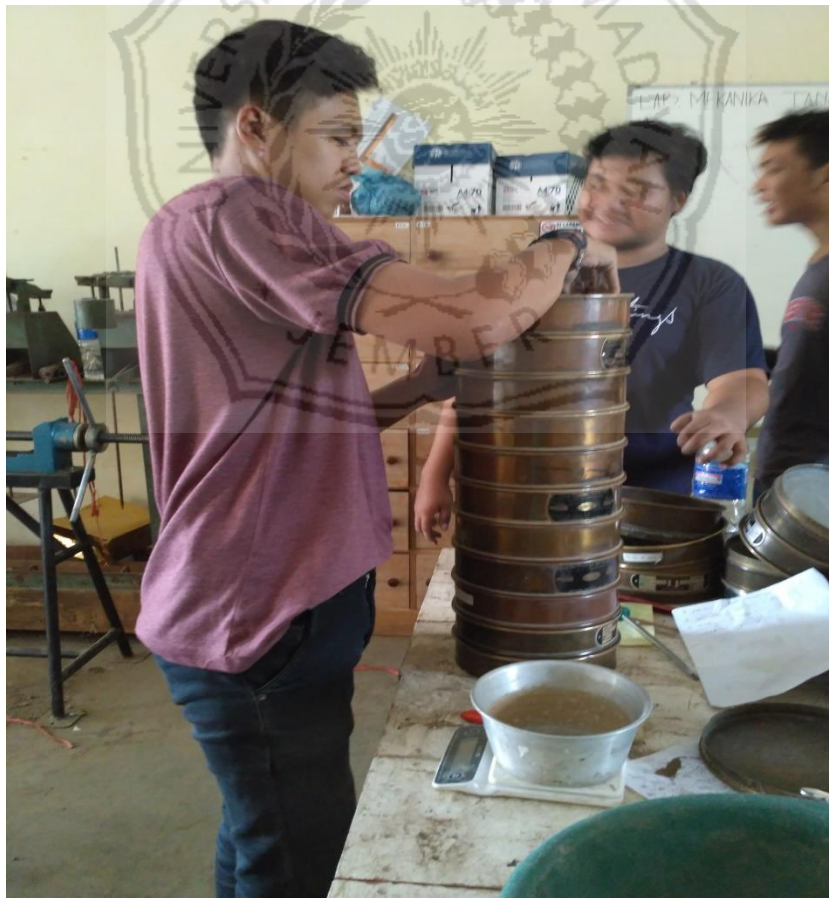
Uji analisa saringan di laboratorium tanah
