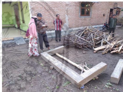
Persiapan beton Untuk di Uji Tekan Sebelum Pembakaran
