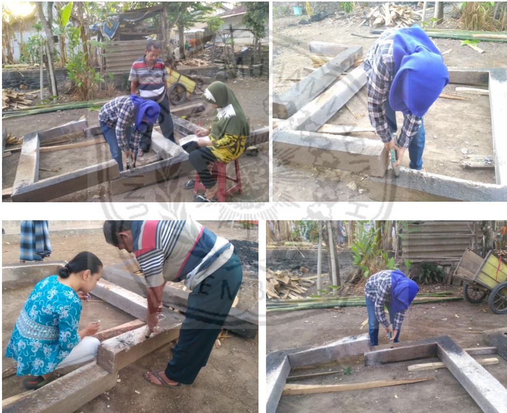
Uji Kuat Tekan Beton Menggunakan Hammer Test Setelah Proses Pembakaran
