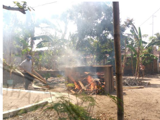
Proses Pembakaran Benda Uji (Portal Beton Bertulang)
