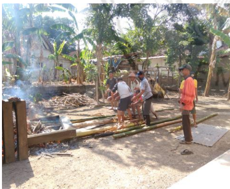
Proses Pengambilan Benda Uji Saat Proses Pembakaran Dengan Waktu (0,5 jam ; 1jam ; 1,5 jam dan 2jam)
