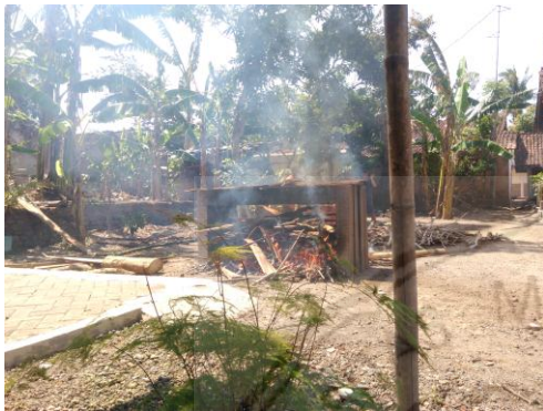
Proses Pembakaran Benda Uji (Portal Beton Bertulang)
