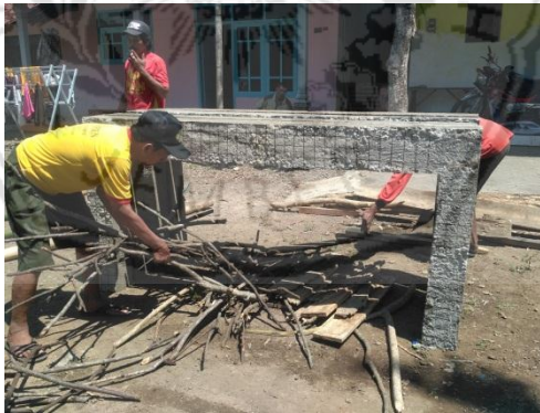
Persiapan Benda Uji untuk proses Pembakaran
