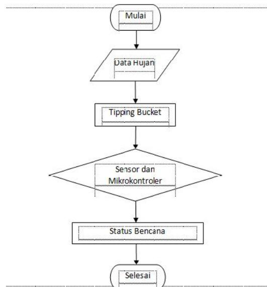
Gambar. Diagram alir cara kerja alat sensor
