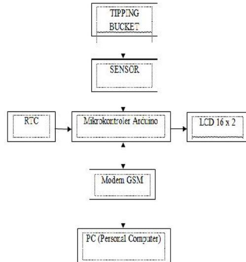
Gambar. Skema susunan alat sensor
