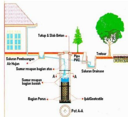
Gambar 1. Contoh pot A-A sumur resapan pada perumahan
