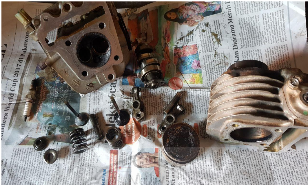
Gambar 3. Bagian komponen ruang bakar mesin standar
