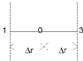
Gambar 4.1. Kisi kisi finite diferensial pada Persamaan Deferensial Vertikal Sand Drain
