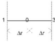
Gambar 4.1. Kisi kisifinite diferensial pada Persamaan Deferensial Vertikal Sand Drain
